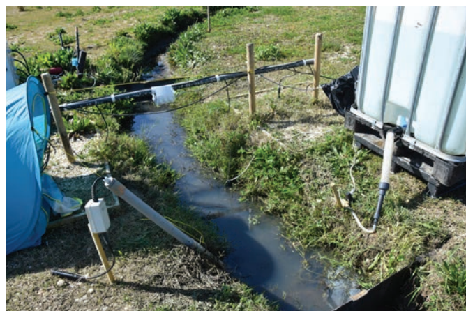
Etude de l'infiltration du sol d'une ZRV fossé à son démarrage © Irstea
