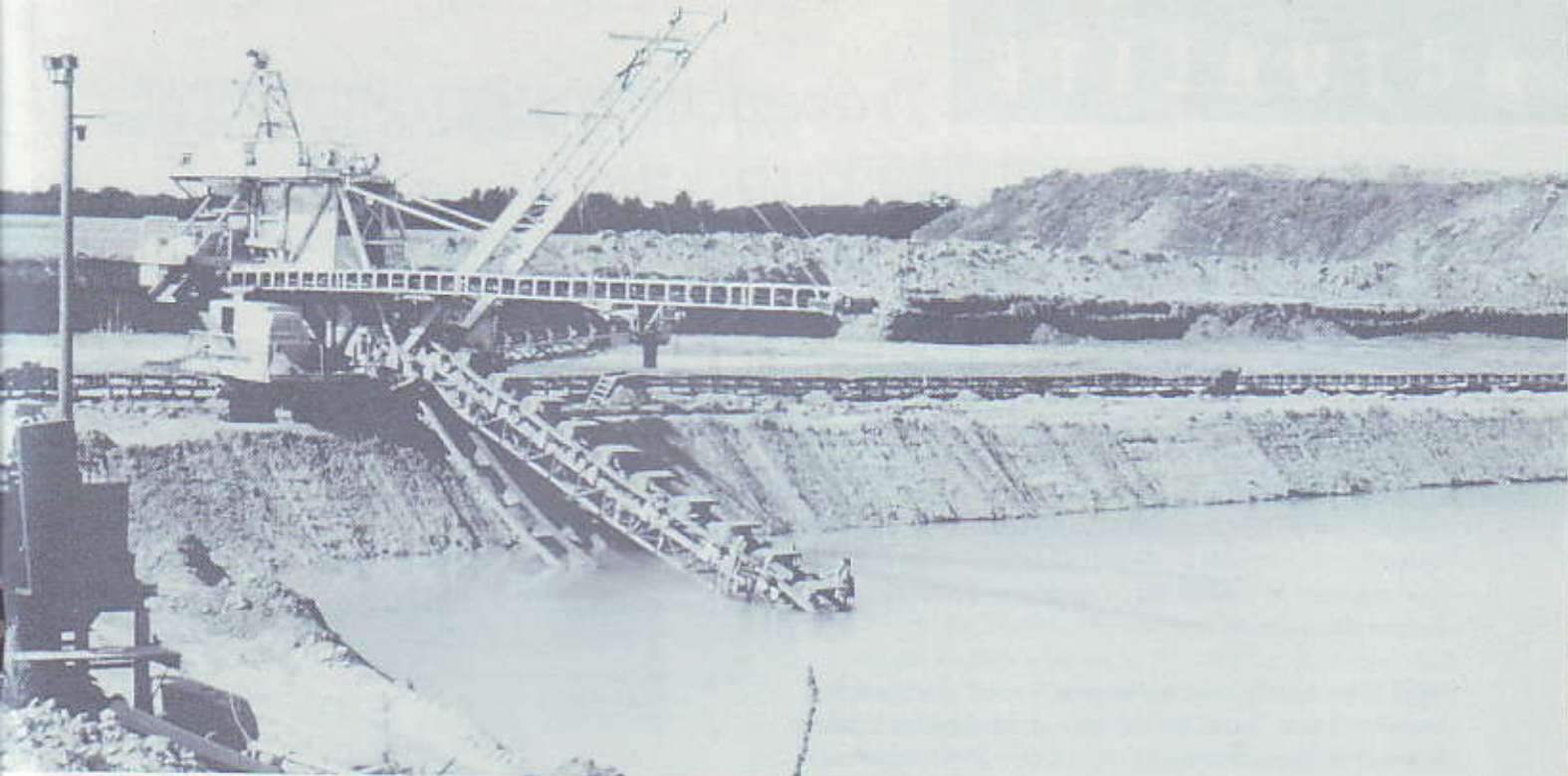
Sur cette photo, le sable est directement extrait de la nappe alluviale.
