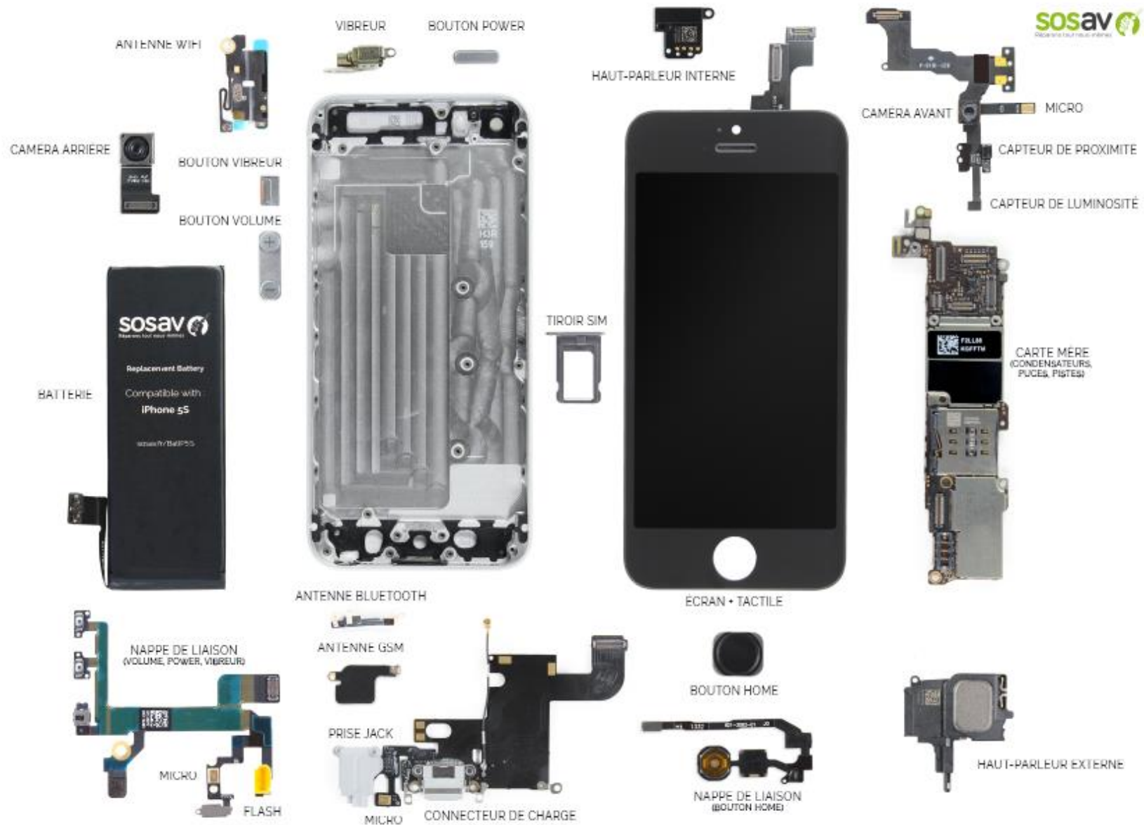
Vue éclatée d'un smartphone (modèle Iphone 5S) - Source : SOSav
